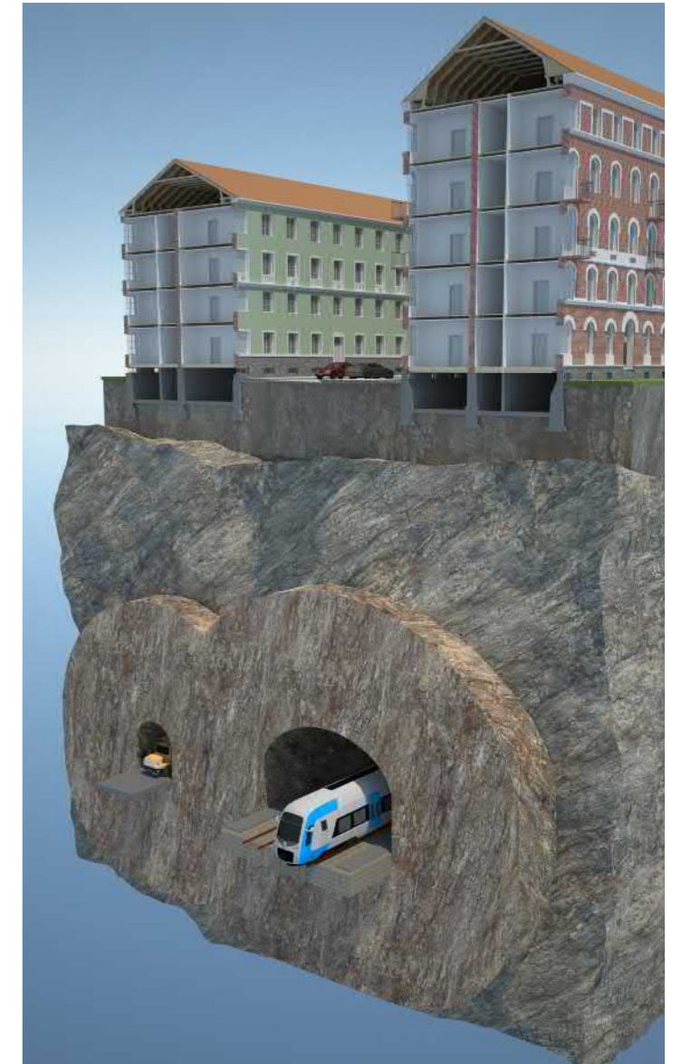
Figur 23. Illustration av bergtäckning.
